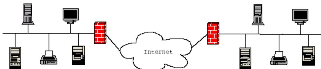
Abb. 3.1: Prinzip eines VPN
